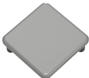
BG 5111 Topp plugg stolpe 53 x 53 mm. Egner seg best som topp plugg når det ikke er topprekke. Er litt større enn stolpen for å hindre at det kommer vann inn i stolpen.
